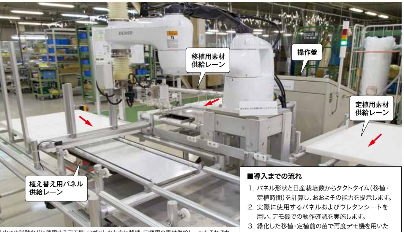
社内の試験などに使用するデモ機。ロボットの左右に移植・定植用の素材供給レーンをそれぞれ設けており、ハンドを交換することでどちらにも使える仕様。閉鎖型植物工場の湿度の高さに対応するため、錆や防水の対策にも力を入れている。
