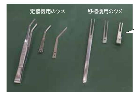
ツメの進化の過程。それぞれ左から「手づくりしていた際に元となった日用品(ピンセットと和菓子用フォーク)」、加工したツメ、工作機で量産化した現在の部品。表面の細かい加工は量産時の改良で加えられた。(ツメはいずれも特許出願中)
